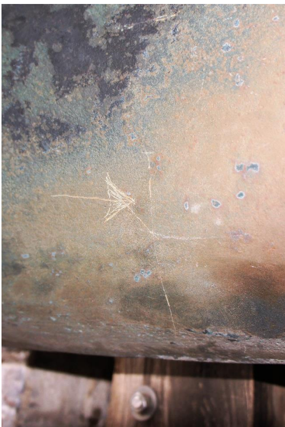
Harte-klokken før og efter svejsning. Tv. ses bruddet i slagringen fra klokkens inderside, mens den færdige svejsning ses fra klokkestykkets yderside på billedet th. Foto PRM 2013.
