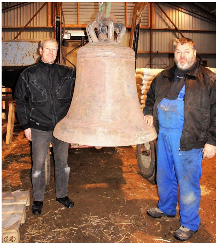
Svejsningen af Harte-klokken skete gennem fa. Thomo Klokkerservice, Fyn. Tv. ses den daværende ejer Roscoe Mortensen, mens medarbejder Erik Stage Jørgensen ses th. Bemærk at klokken har mistet en del af sin naturlige patina ved opvarmningen. Foto PRM 2013.
