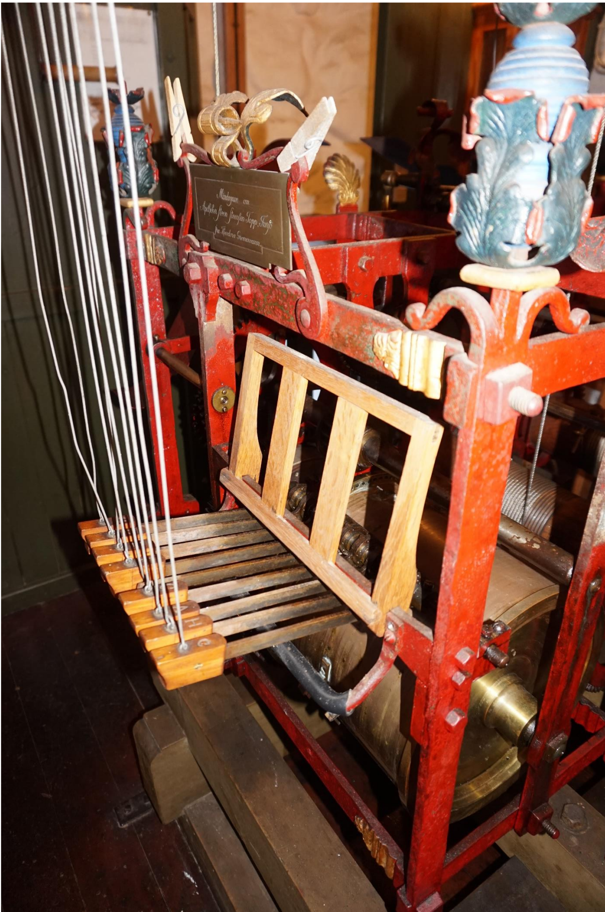
Ved hjælp af de primitive tangenter på vippearmenes udragende ender er det muligt at spille manuelt på klokkerne. Det kræver dog nogen øvelse, da hammerværket løftes fra ved tangentens nedtrykning, og anslaget på klokken først kommer i det øjeblik, tangenten returnerer. Foto PRM 2020
